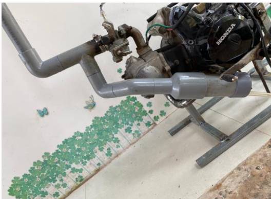
Hình 6. Thi công hệ thống nạp nhiên liệu có tách nước
